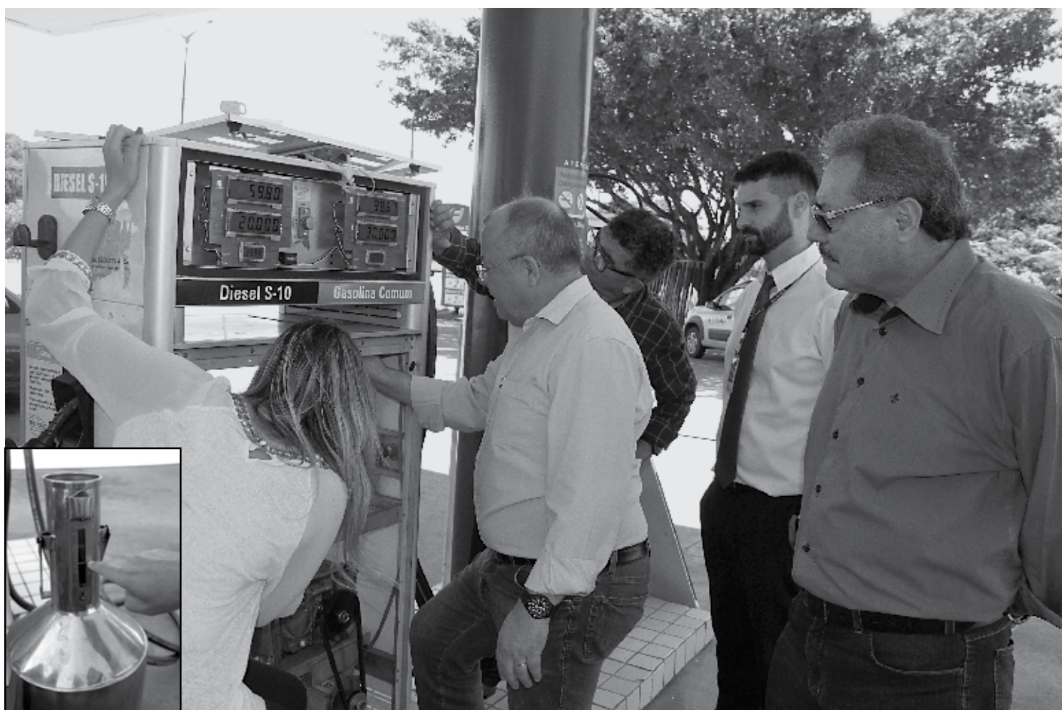
Fiscais do Imeq utilizam um equipamento conhecido por medidor de capacidade e também verificam os lacres das bombas existentes nos postos
